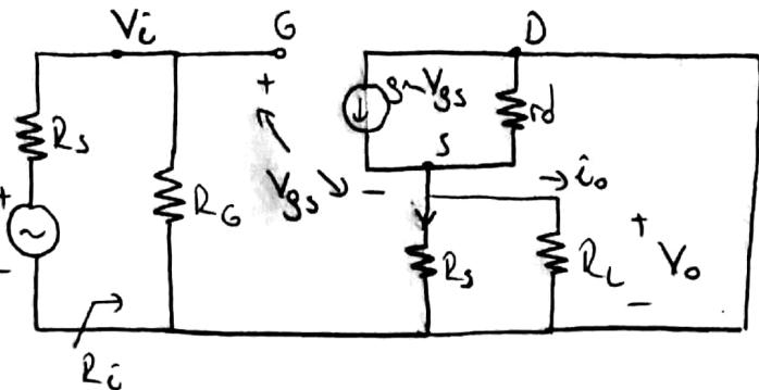
$$A_v = \frac{V_o}{V_s} \quad V_o = g_m V_{gs} \cdot \underbrace{(r_d // R_s // R_L)}_{R_{eq}} \quad V_i = V_{gs} + V_o \quad V_i = \frac{V_s}{(R_s + R_G)} \cdot R_G$$
