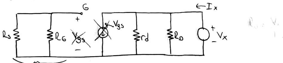
Girişte herhangi bir kaynak olmadığı için  $V_{GS} = 0$  olursa dolayısıyla  $g_m \cdot V_{GS}$  akım kaynağında 0 olur.
