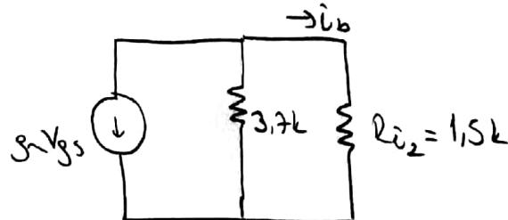
$$i_b = -g_m V_{gs} \cdot \frac{3,7 \cdot 1,5}{3,7 + 1,5} - \frac{1}{1,5} = -g_m V_{gs} \cdot 0,711$$
