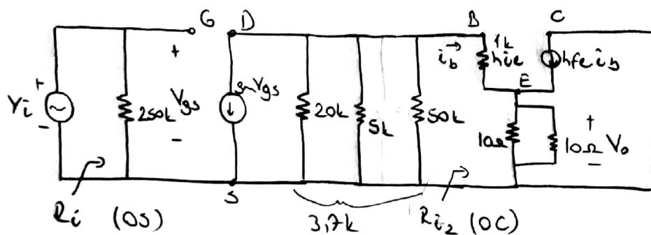
$$A_v = \frac{V_2}{V_i} = \frac{V_o}{V_D} \cdot \frac{V_D}{V_i} \quad V_o = i_b(1+h_{fe}) \cdot 0,005 \text{ k}\Omega = 10i_b \cdot 0,005 = 0,05i_b$$
