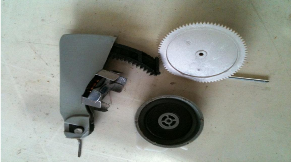
Şekil 2.2. Generatörde doğrusal hareketi sağlayan kol ve dairesel hareketi sağlayan malzemeler
